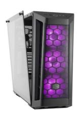
Edge to Edge 4mm thickness Tempered Glass Side Panel
